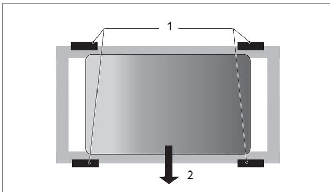
2. Achten Sie darauf, dass die Bremsen (2) angezogen und alle Räder ordnungsgemäß mit dem mitgelieferten Splint (1) gesichert sind.
